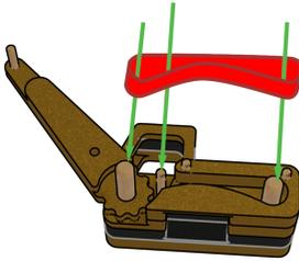
Enfiler un élastique autour des deux axes en incluant la tige du milieu. (voir image ci-contre et suivante).
