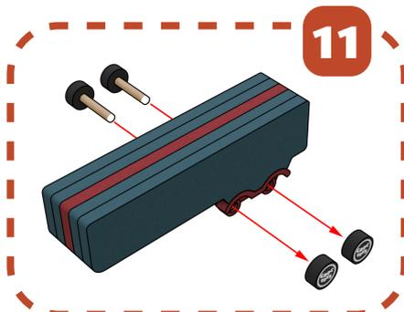
Coller les roues restantes en passant à travers le châssis.
